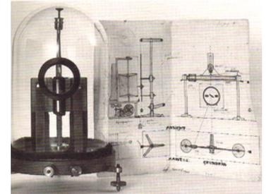
Le galvanomètre mis au point et utilisé par Jung au Burghölzli pour enregistrer la réponse électrodermale aux mots de l'inducteur. Les plans sont de la main de Jung.
